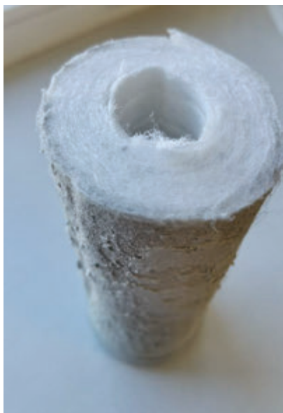
Рисунок 8 – Разрез фильтрующего элемента после испытаний
