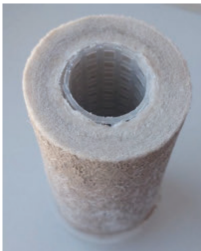
Рисунок 9 – Разрез фильтрующего элемента 10 после испытаний
