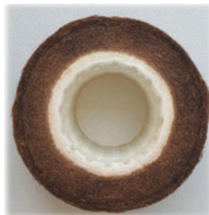
Рисунок 10 – Разрез фильтрующего элемента FTOV FP
