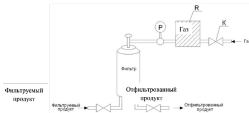
Схема контроля целостности фильтров по давлению
