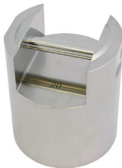
Рис. 4. Гиря М1 20 кг из нержавеющей стали
