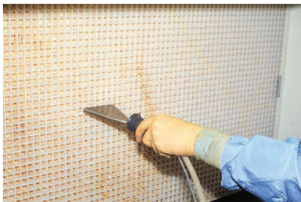
Рис. D.1 Сканирование лицевой поверхности фильтра для обнаружения утечки
