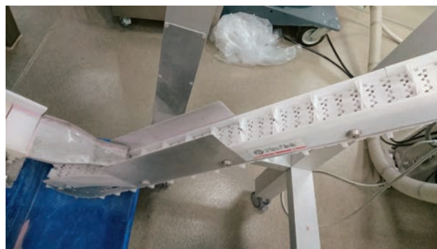
Рис. 5 Решение для подъёма таблеток с уровня выхода металлодетектора на уровень входа машины для упаковки таблеток в тубы, в условиях ограниченной площади помещения.
