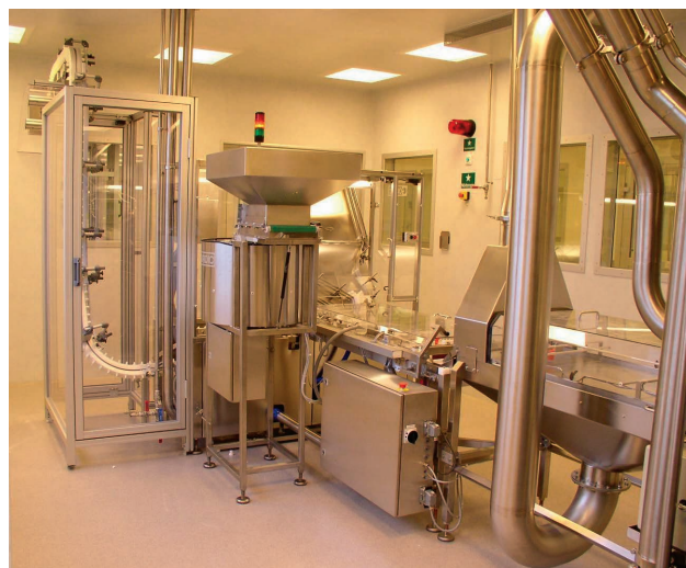
Рис. 4 Линия упаковки таблеток в тубы. Слева выход конвейера с наполненными тубами за пределы чистой зоны, на картонажную машину. Справа система Airslide для бережной подачи шипучих таблеток на «воздушной подушке». По центру основные узлы машины (стол для счёта таблеток, бункер для загрузки крышек, устройство для загрузки туб в преднаполненные каскеты). Движущиеся части машины снабжены ограждениями для защиты оператора.
