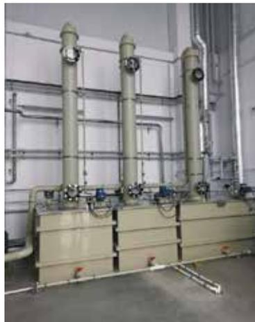
Собственная стерилизационная установка (газовая стерилизация с применением оксида этилена)
