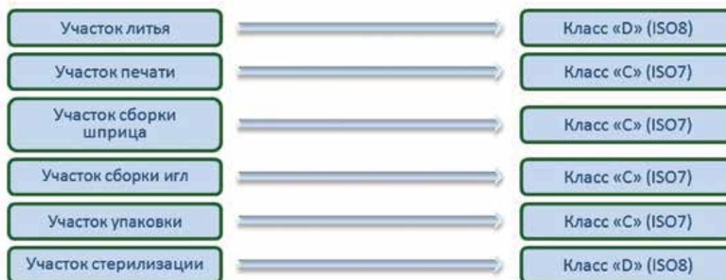
*Рис. 8 Классификация помещений по классам чистоты. Классы ИСО даны в оснащённом состоянии*
