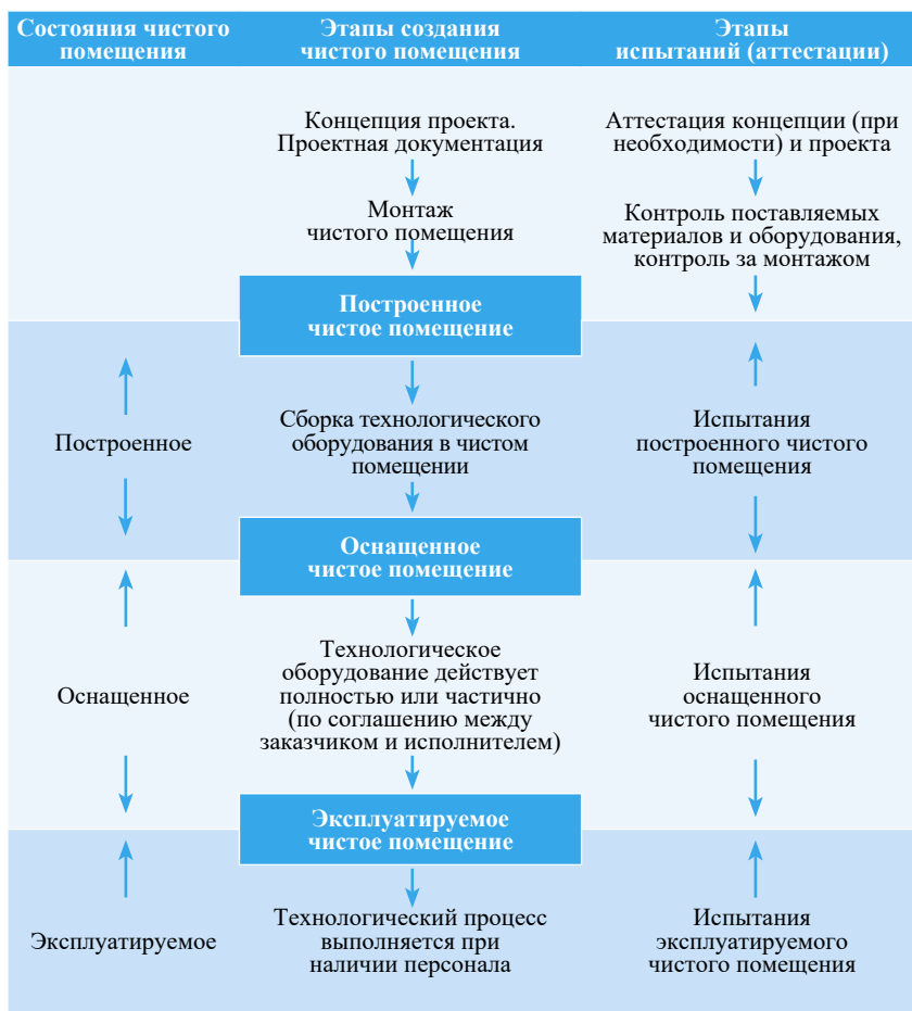
Рис. 1. Этапы испытаний (аттестации) чистых помещений
