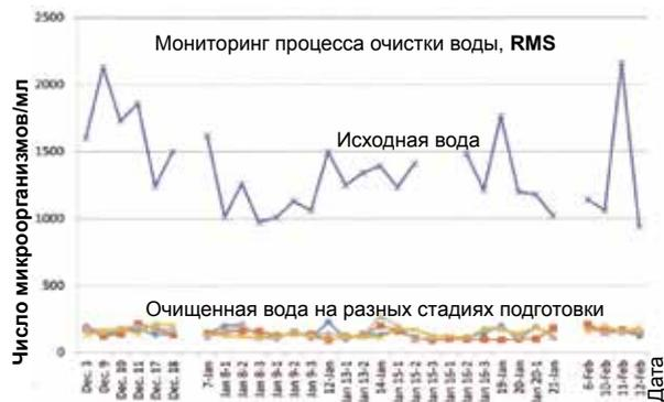
Рис. 3. Результаты мониторинга жизнеспособных частиц на различных стадиях подготовки воды
