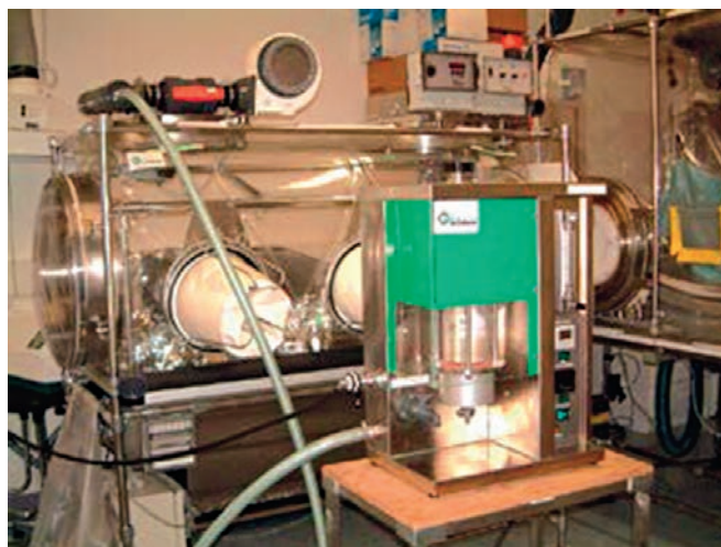
Рис. 2. Устройство La Calhene MAN 230, подсоединенное к изолятору с гибкими стенками
