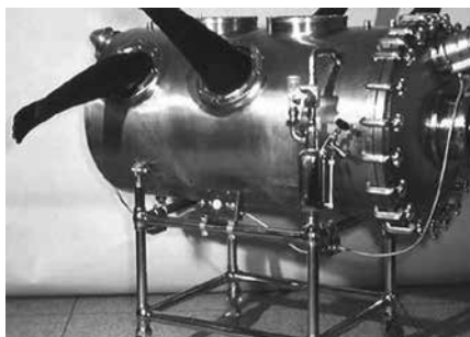
Рис. 1. Металлический изолятор, стерилизуемый паром (Университет Нотр Дам, США)
