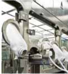
Передаточное устройство для передачи жидких материалов фирмы Getinge
