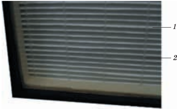
Рис. 8. Фрагмент фильтра с нитевыми сепараторами 1 – фильтрующий материал; 2 – платиновая нить
