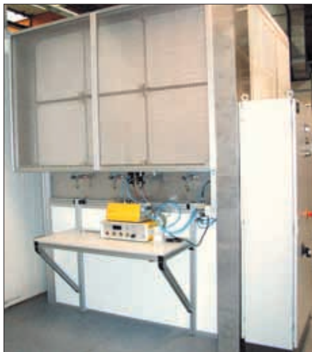
Блок очистки исходного воздуха
