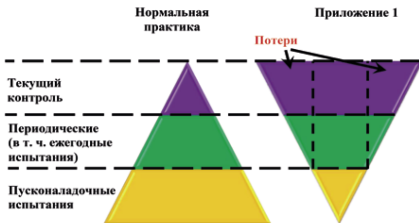
Рис. 4. Отношения между объемами работ при испытаниях и текущем контроле
