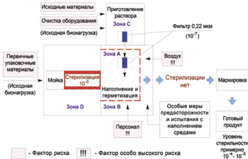
Рис. 5. Асептический процесс (открытый) – анализ рисков
