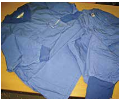
Рис. 3. Комплект хирургической одежды из смесового материала: 69 % хлопка, 30 % полиэфирного волокна и 1 % углеродных нитей
