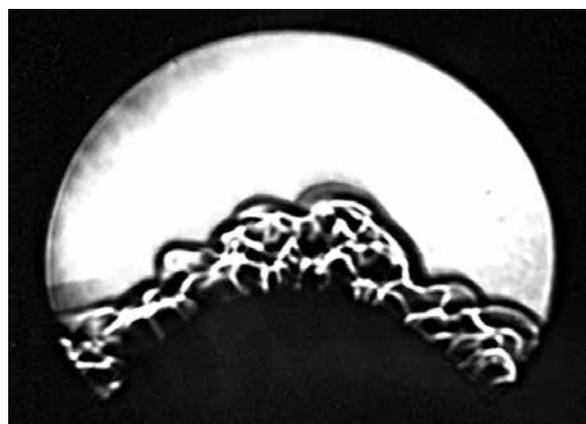
Рис. 7. Фотография Шлирена, показывающая горячий воздух на поверхности лампы с высокой температурой в условиях нисходящего однонаправленного потока 0,3 м/с
