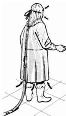
Рис. 2. Одежда Чарнлея с полной вытяжкой воздуха
