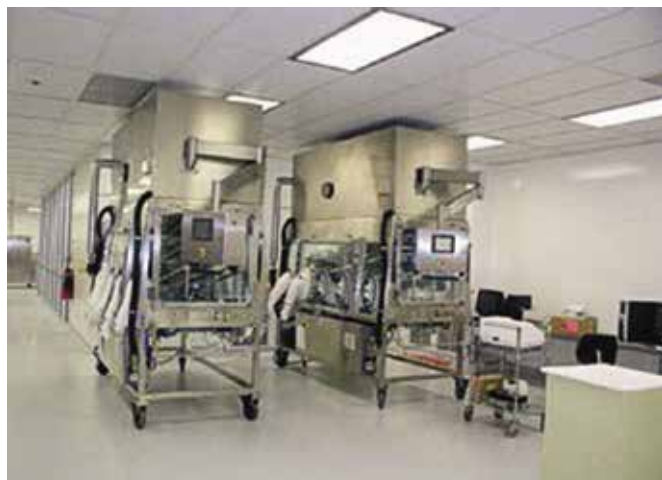
Рис. 11. Два изолятора для передачи контейнеров со шприцами, Baxter Healthcare, США
