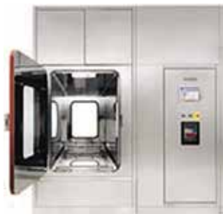
Рис. 3. Камера деконтаминации при низкой температуре Федегари ( Fedegary )
