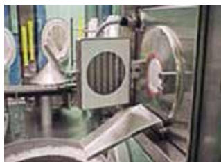
Рис. 14. УФ-система для передачи пробок в изолятор фирмы Millipore, США (вид изнутри)
