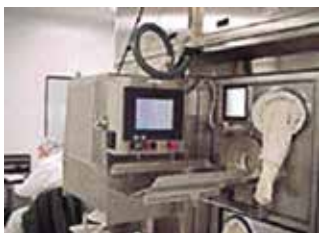
Рис. 13. УФ-система для передачи пробок в изолятор фирмы Millipore, США (вид снаружи)
