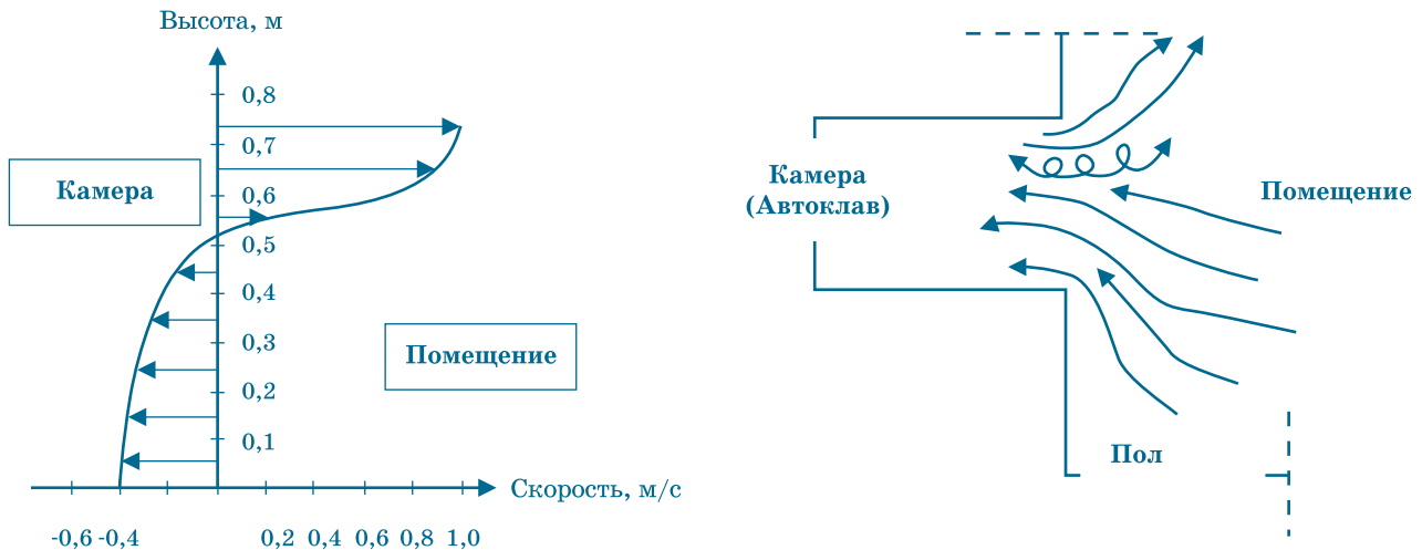
Рис. 8. Диаграмма скоростей воздуха (в начале измерений) и визуальная картина движения воздуха внутрь и наружу автоклава через открытый проем
