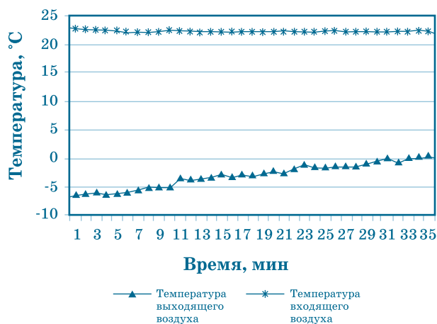
Рис. 7. Результаты измерений температуры входящего и выходящего воздуха для лиофильной сушилки. Дверь была открыта через 2 минуты
