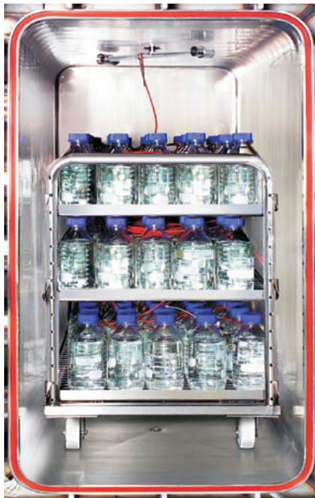
Типичная конфигурация загрузки камеры стерилизатора. Тип загрузки – жидкости в мягкой упаковке
