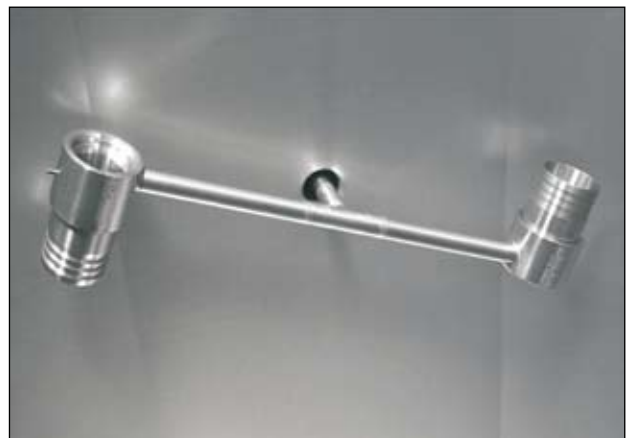
Эжектор, установленный в потоке камеры стерилизатора
