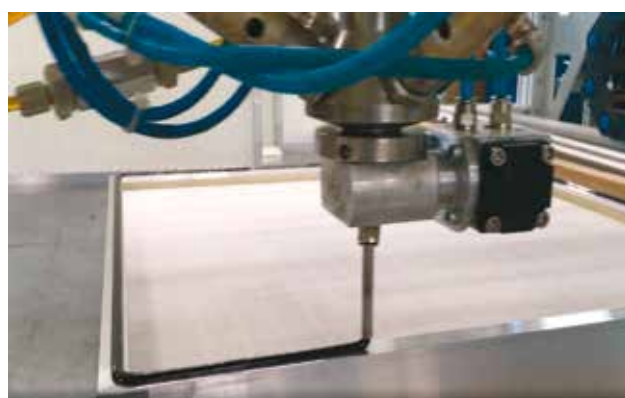
Рис. 6. Нанесение вспененного полиуретанового уплотнения на воздушные фильтры
