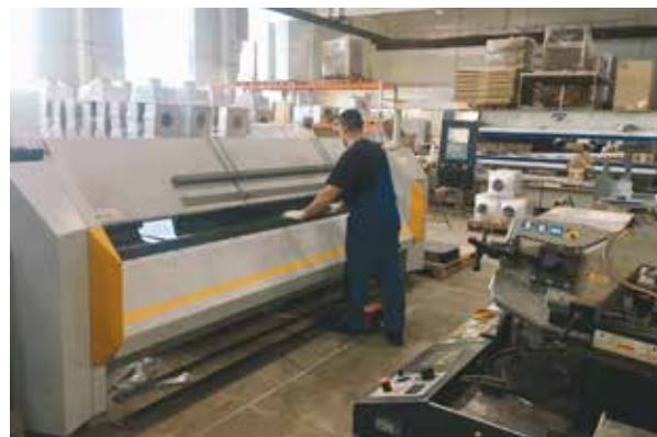
Рис. 8. Гибочный станок для изготовления панелей
