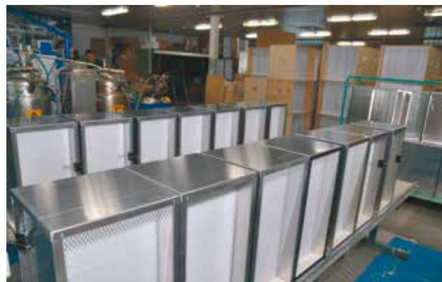
Рис. 4. Воздушные фильтры на столе заливки герметика
