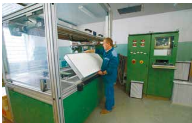
Рис. 5. Стенд для определения сопротивления потоку воздуха, локальной и интегральной эффективности
