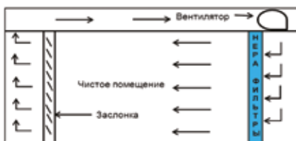
Горизонтальный поток воздуха «от стены к стене»
