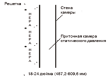
Замена фильтров снаружи камеры
