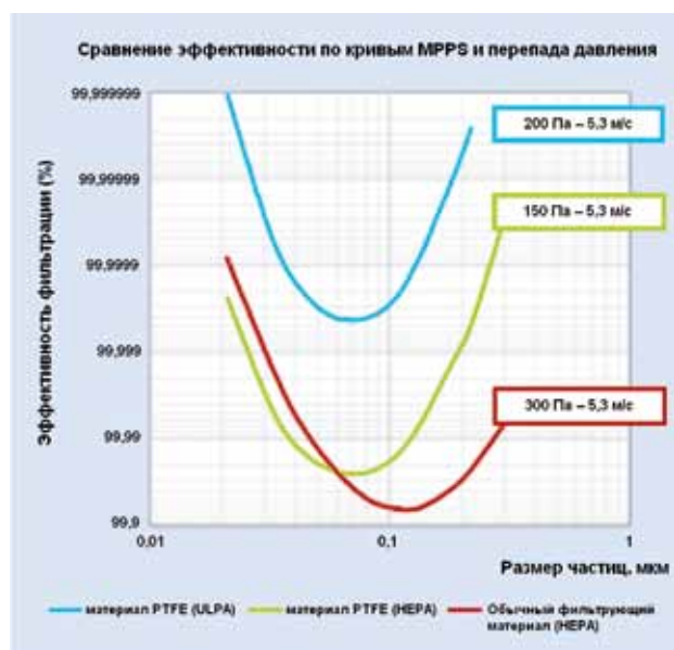
Рис. 1. Сравнение эффективности по кривым MPPS и перепада давления для плоских фильтрующих элементов HEPA и ULPA фильтров по технологии NELIOR с обычным фильтрующим материалом при скорости воздуха 5,3 м/с
