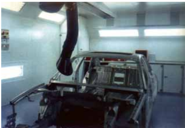
Рис. 4. Чистое помещение предприятия Wayside Bodyshop для ремонта алюминиевых автомобилей
