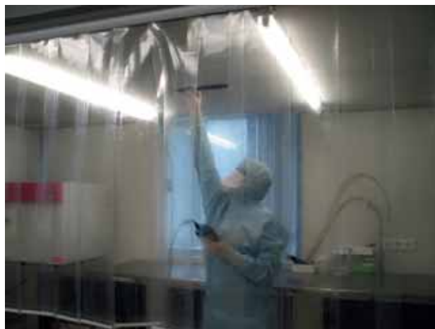
Рис. 8. Измерение скорости однонаправленного потока воздуха при аттестации ламинарной зоны (ООО «Диамед», г. Москва)
