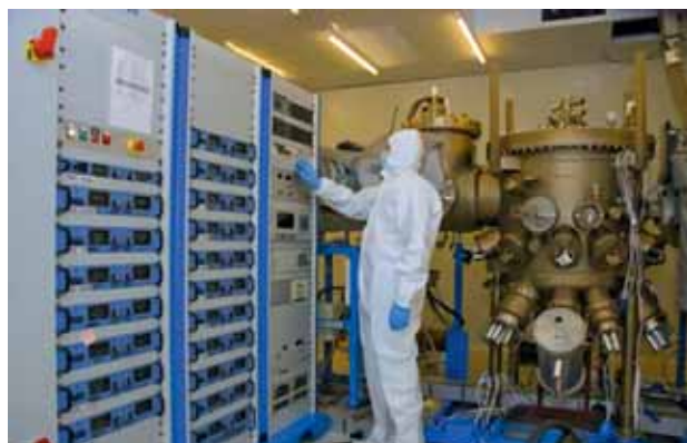
Промышленная установка для изготовления лазерных и транзисторных структур Riber 49
