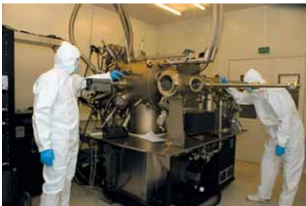
Исследовательская установка молекулярно-пучковой эпитаксии VEECO GEN III
