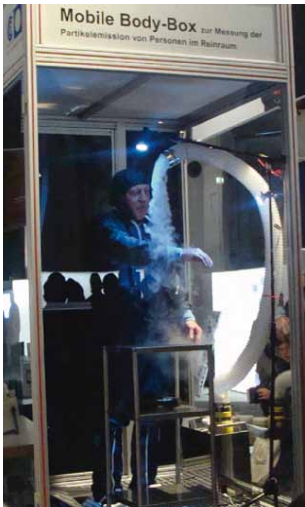
Передвижной стенд для испытаний одежды для чистых помещений
