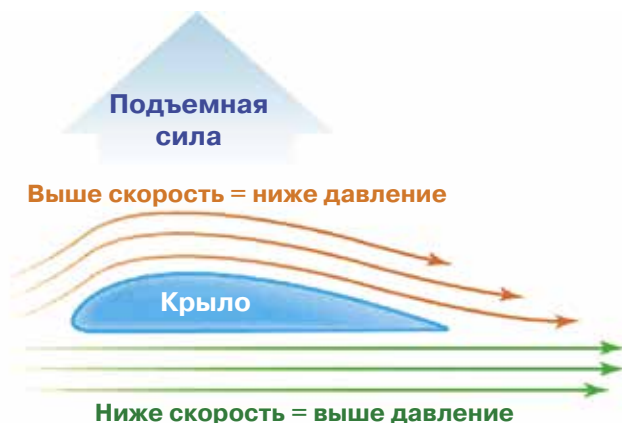
Рис. 1. Обтекание крыла самолета потоком воздуха
