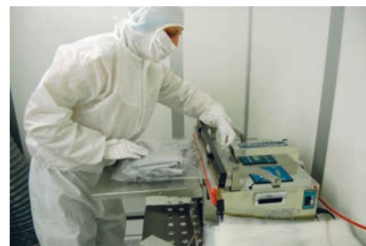
Рис. 10. Прачечная для особо чистой одежды: а) процесс стирки; б) процесс вакуумной упаковки
