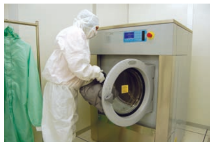
Рис. 10. Прачечная для особо чистой одежды: а) процесс стирки; б) процесс вакуумной упаковки
