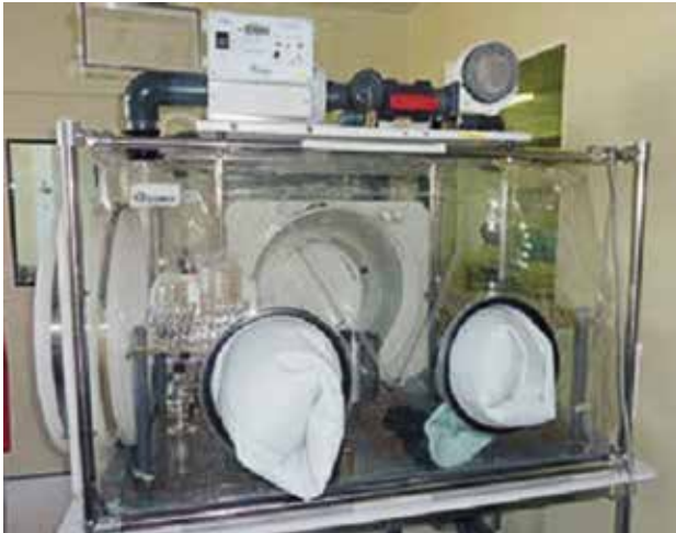
Рис. 2. Изолятор для проведения контроля стерильности фирмы La Calhene, 1980 г.
