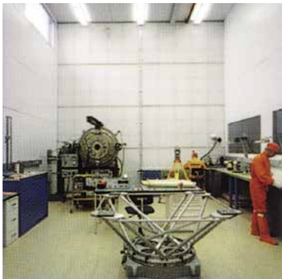
Рис. 2. Чистое помещение сборки космических аппаратов, построено фирмой Zellweger Luwa, Швейцария
