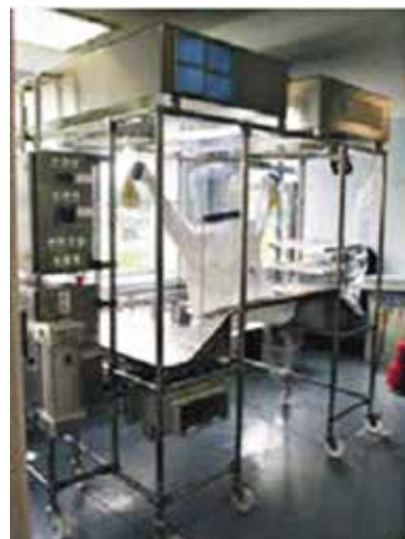
Рис. 5. Типичный изолятор из гибких пленок с полукостюмом фирмы Pharminox Isolation Limited, Великобритания
