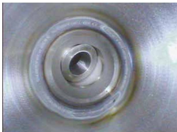
Рис. 5. Фото сварного шва с помощью эндоскопа, ржавчина наблюдается в зоне термического влияния сварки
