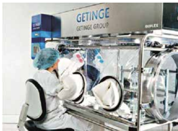
Рис. 6. Изолятор из гибких пленок Isoflex фирмы Gettinge – La Calhene
