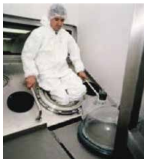
Рис. 8. Подготовка ко входу в изолятор с применением полного костюма-скафандра Scalhene
