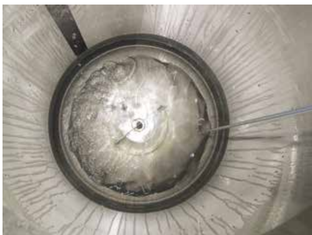
Рис. 1. Емкость Воды для инъекций, наблюдается окрашивание ткани во время протирки
