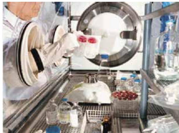
Рис. 7. Изолятор Isoflex, вид изнутри
