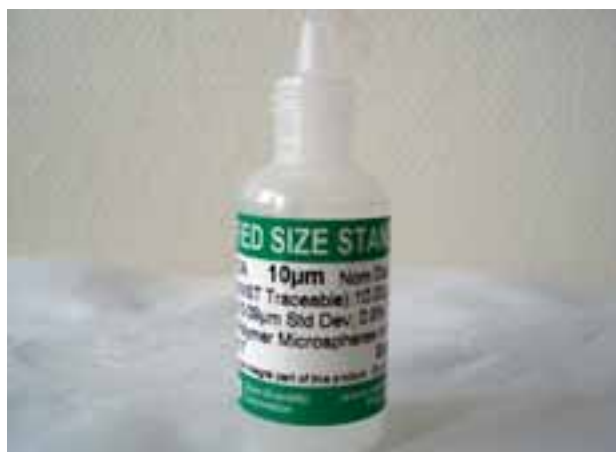
Рис. 2. Флакон с полистирольными латексными частицами размером 10 мкм
